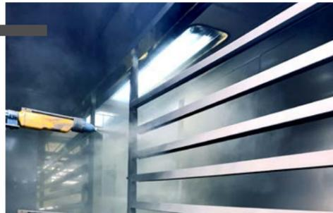
Lackierung aller unserer Produkte innen und außen mit unserer automatischen Pulverbeschichtung inklusive kontrollierter Metallreinigungsanlage und zertifiziertem QUALICOAT-Standard.
